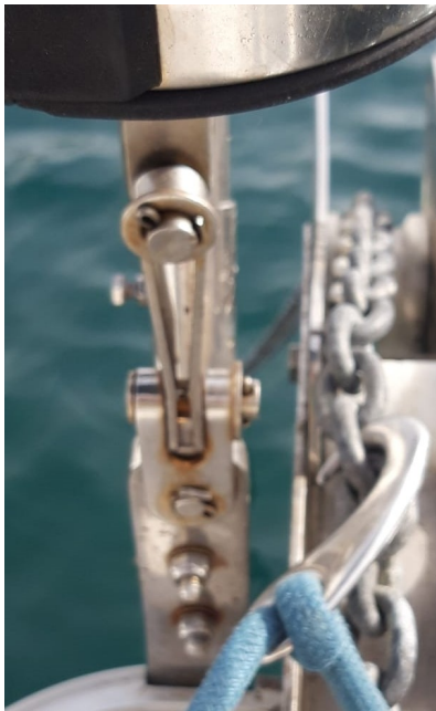
Nytt sätt att avlasta ankarkättingen
